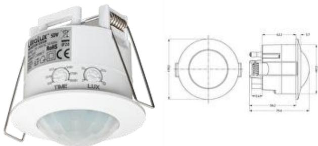
El sensor de empotrar SDV de ULTRALUX es detector pasivo infrarrojo, el cual mide (detecta) los rayos infrarrojos (calor) emitidos por los objetos alojados en su área de detección. Dependiendo de los cambios térmicos en su área de detección, el sensor enciende/apaga la carga conectada. Por lo cual el sensor SDV no se recomienda montar en zonas con grandes cambios térmicos – cerca de climatizadores, estufas y otros fuentes de calor.
